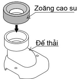
Để cho lắp đặt thuận tiện, trước khi lắp đặt, hãy bôi nước vào vành trong Zoăng cao su. Dùng tay mở rộng miệng Zoăng, sau đó lắp bao ngoài miệng đế thải (chú ý phải ấn Zoăng cao su xuống tận cùng để tránh rò nước và khí).
