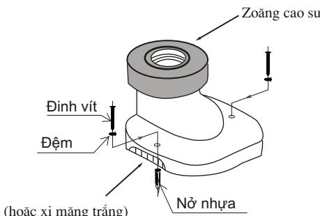
4. Đặt đế thải vào lỗ chò, điều chỉnh cho thẳng góc với tường dùng vữa trát tường cố định 2 cạnh đế thải xuống nền nhà
