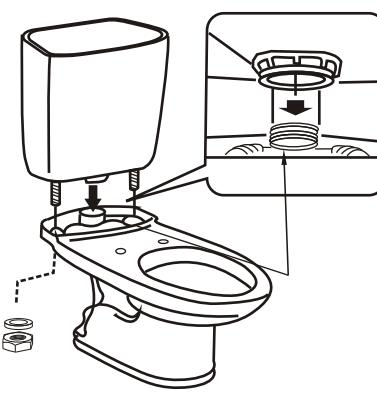
**8. Lắp két nước vào bàn cầu : Trước hết bắt chân ốc vào thân Tank, sau đó gắn Tank vào thân bệt sao cho đầu ống phân phối nước cắm vào lòng miệng van xả trong thân Tank. Các ốc bắt vừa chặt.**
