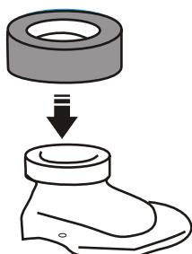
3. Lắp zoăng cao su vào đế thải. Yêu cầu phải lắp gioăng ôm khít vào ống để thải kể cả phần xung quanh và phần trên miệng ống để thải, đảm bảo cho đế thải với gioăng kín không bị rò khí & nước.
